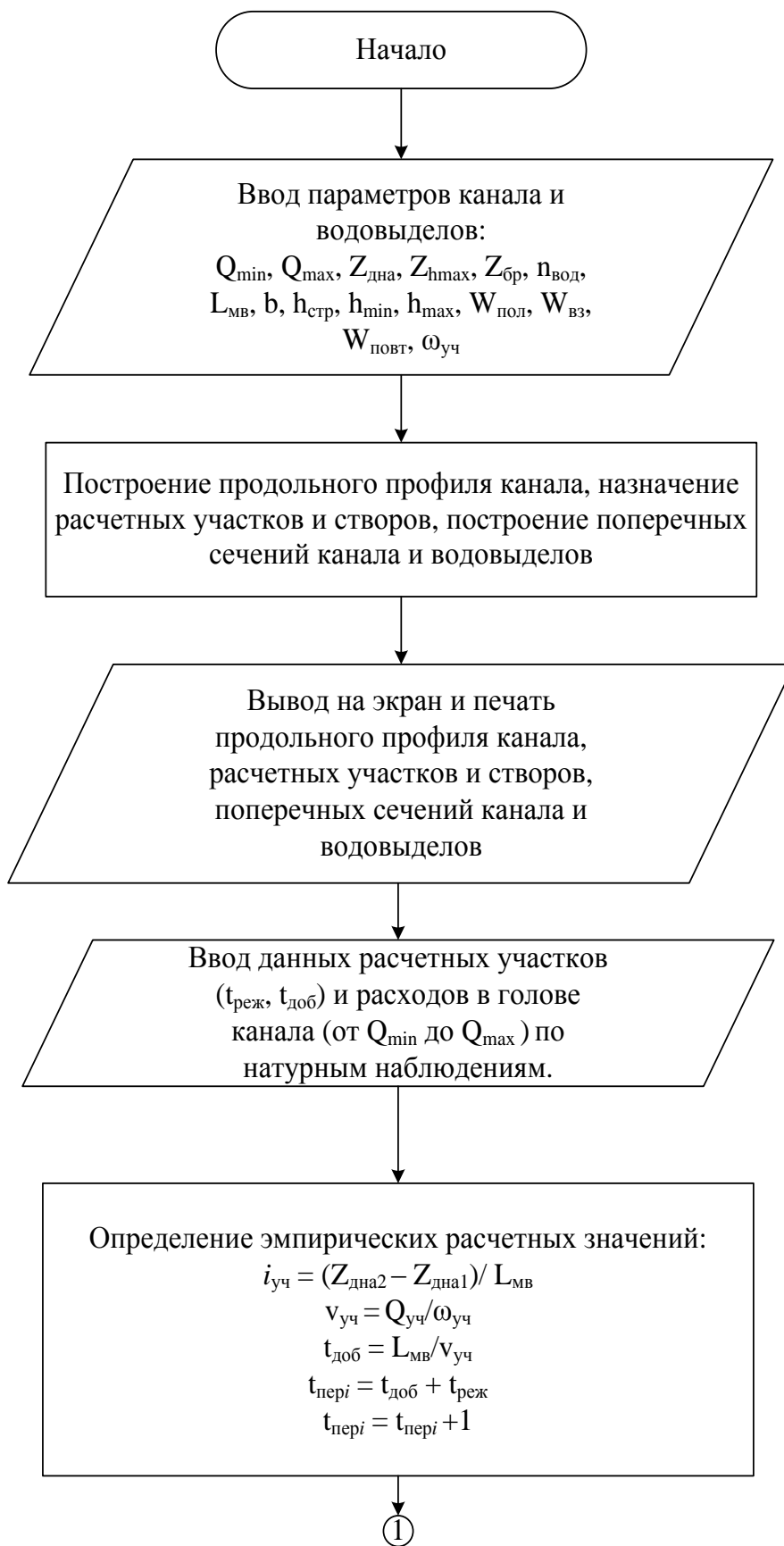
Рисунок 5, лист 1 – Алгоритм программы реализации модели динамического управления процессами водораспределения на канале открытой оросительной сети
